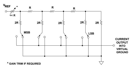
$V_{\mbox{\scriptsize REF}}$  CAN BE AC,  $\pm$  ,ALLOWING FOUR-QUADRANT OPERATION
