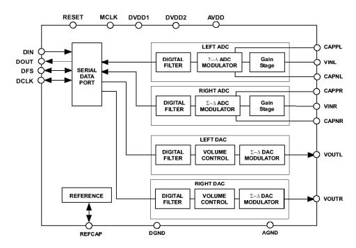
Figure 8.66: AD74122 16-/20-/24-Bit, 48-kSPS Stereo Voiceband Codec
