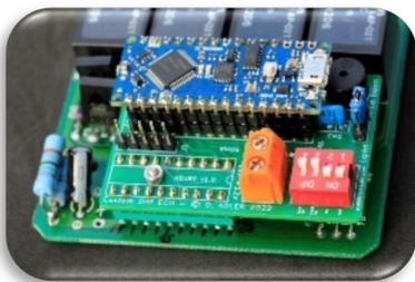
Cette manipulation ne doit être réalisée qu'exceptionnellement pour une éventuelle opération de maintenance. Attention la vis ne doit pas serrer la carte, mais juste la maintenir. Un serrage détériorerait le connecteur 20 broches.
